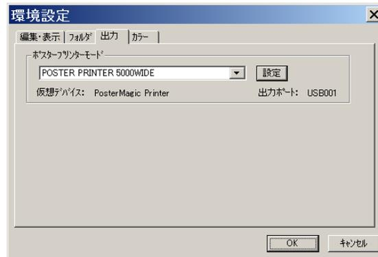
「プリンタ設定」ウインドウが開きます。ポート・スプーラの【設定】ボタンをクリックします。「デバイスの選択」ウインドウが開きます。デバイスリストから「PosterMagic Printer」を選択してください。【OK】ボタンをクリックします。
