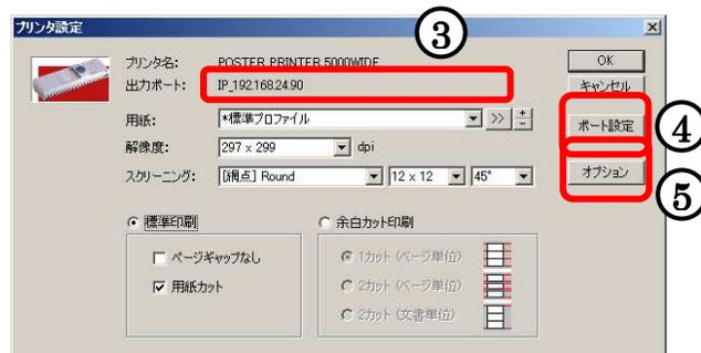
出力ポートの設定がされているかどうか (③) を確認します。出力ポートの欄が空の場合、【ポート設定】ボタン (④) より出力ポートの設定を行います。設定が終わりましたら、『プリンタ設定』ダイアログボックスを閉じます。
